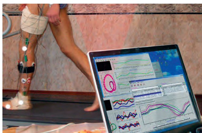
Пакет программ, предназначенных для количественного анализа биомеханических характеристик движений биологических объектов, математического моделирования отдельных движений и целостных двигательных актов. Исследованию подвергается двухмерная (плоская) биомеханическая модель.
